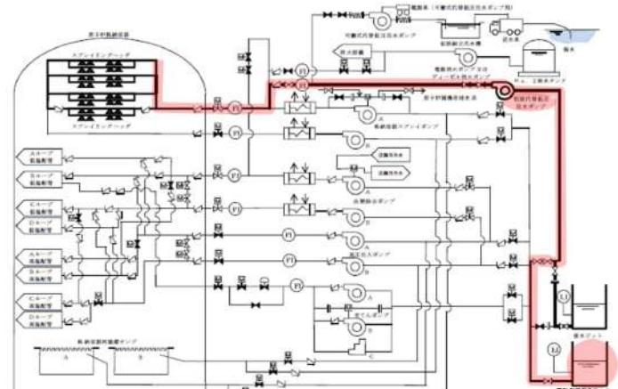
大飯3／4号炉 恒設代替低圧注水ポンプによる代替格納容器スプレイ
