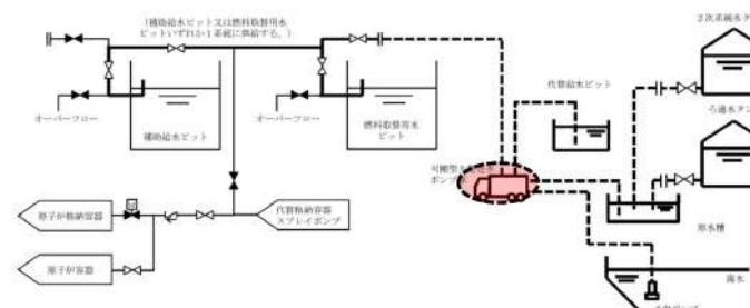
泊3号炉 燃料取替用水ピットへの水源補給
