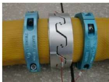
可搬型ホース(150A)接続後
