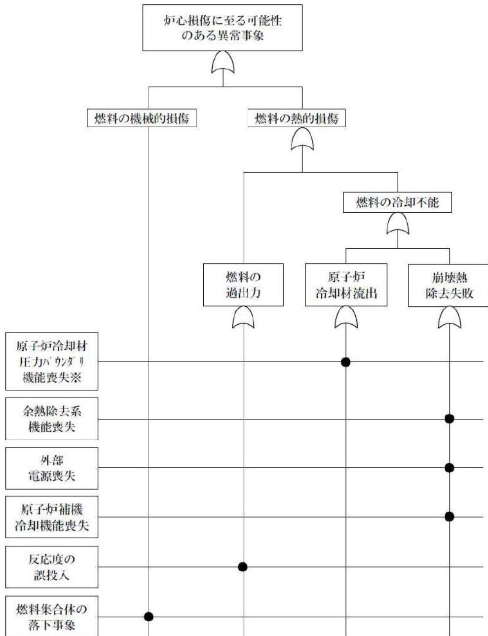
※原子炉冷却材圧力バウンダリ機能喪失、水位維持失敗、オーバードレンを想定
