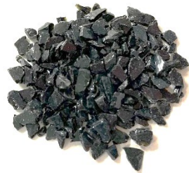
ガラスカレットの外観 (粒径: 1~5 mm 程度)
