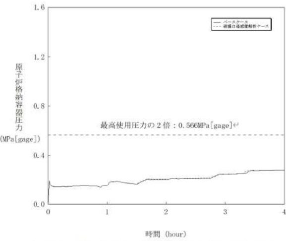
図 4.3-21 原子炉容器の破損口径に関する感度解析結果
