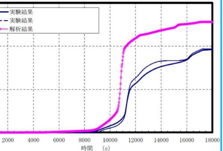
図 4.2-52 PHEBUS-FP 実験 (FPT1) の解析結果 (積算水素ガス量) <sup>[21]</sup>
