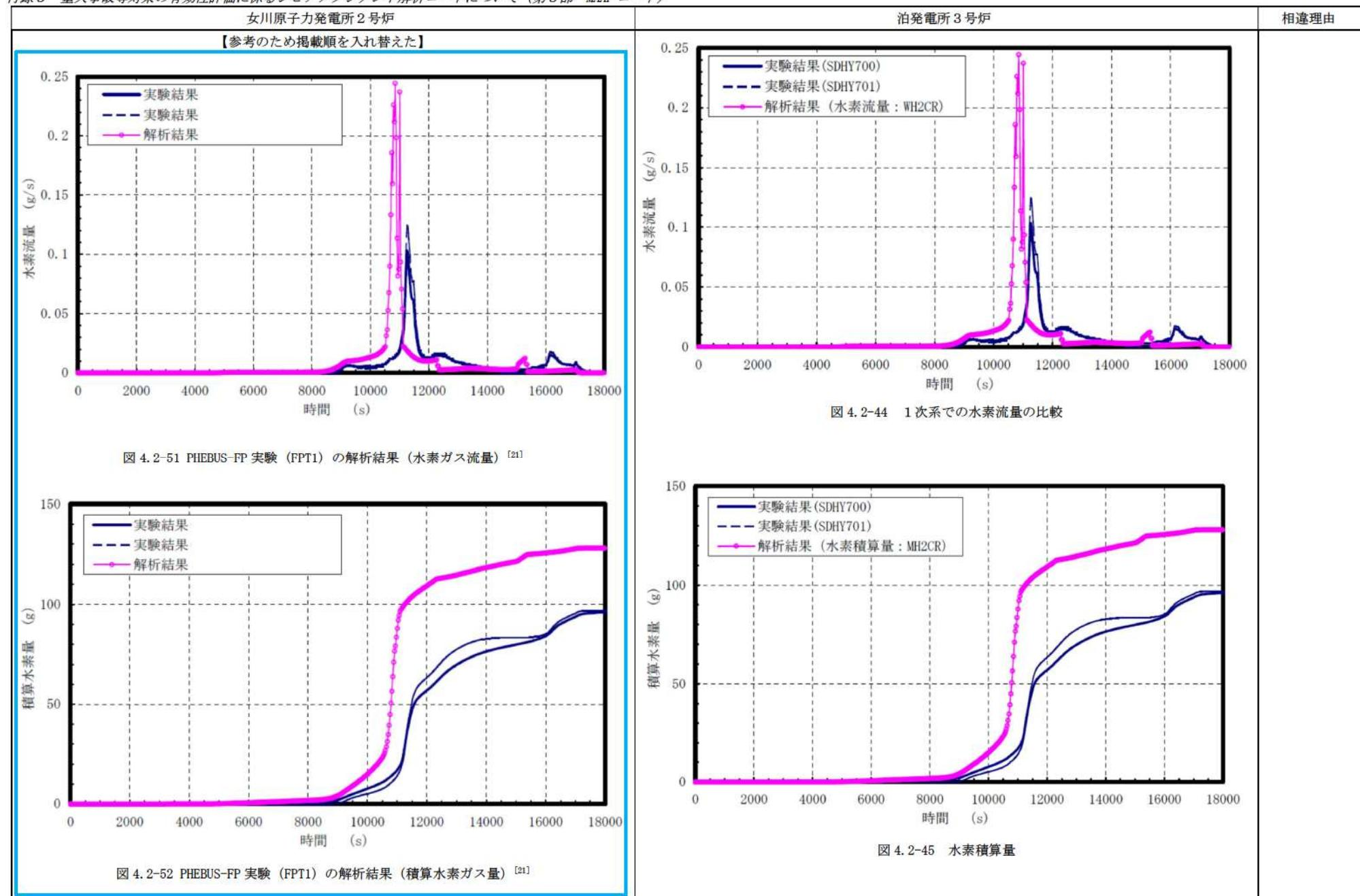
図 4.2-51 PHEBUS-FP 実験 (FPT1) の解析結果 (水素ガス流量) <sup>[21]</sup>
