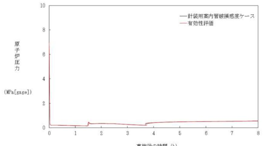
別図1-2.2-1 大破断LOC A時注水機能喪失（原子炉圧力容器破損）における原子炉圧力変化の比較
