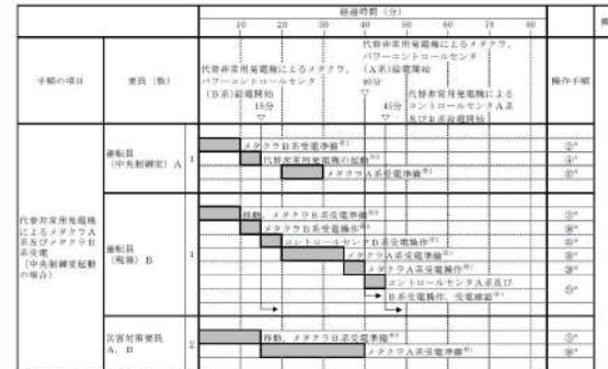
図2.14.15 代替非常用発電機による非常用高圧母線（6-A）及び非常用高圧母線（6-B）受電のタイムチャート*
