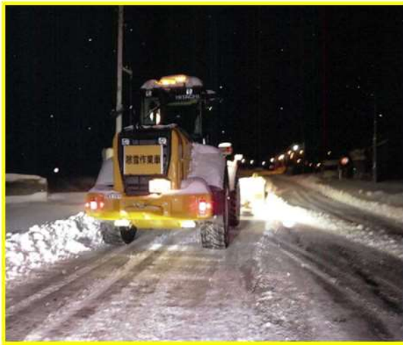
第4-2図 重機による除雪作業 (2)
