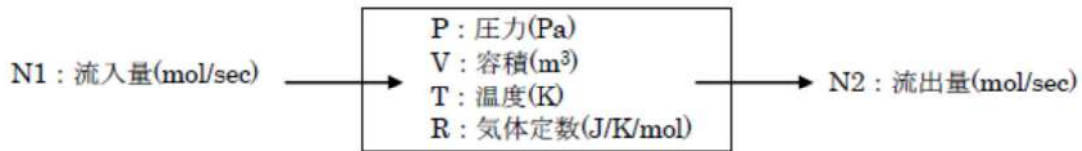
図2.4-10 緊急時対策所指揮所及び緊急時対策所待機所加圧バウンダリ正圧化モデル
