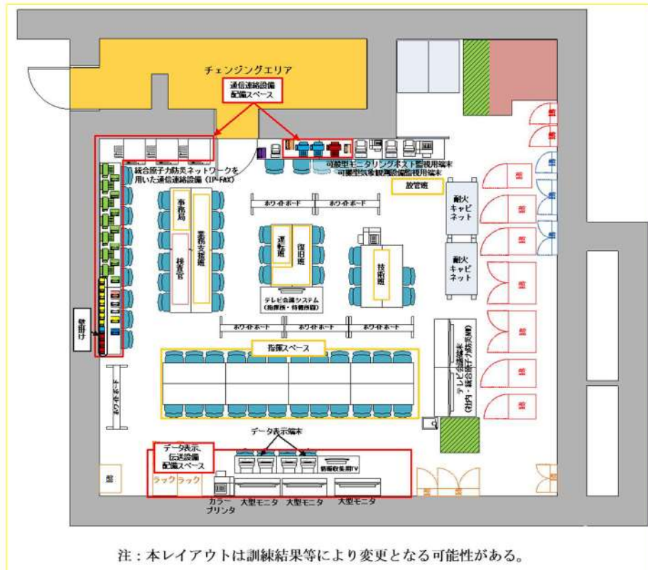
図 2.1-2 緊急時対策所指揮所 レイアウトイメージ図
