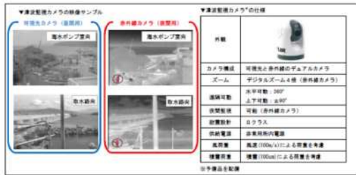
図2-2 津波監視カメラの概要
