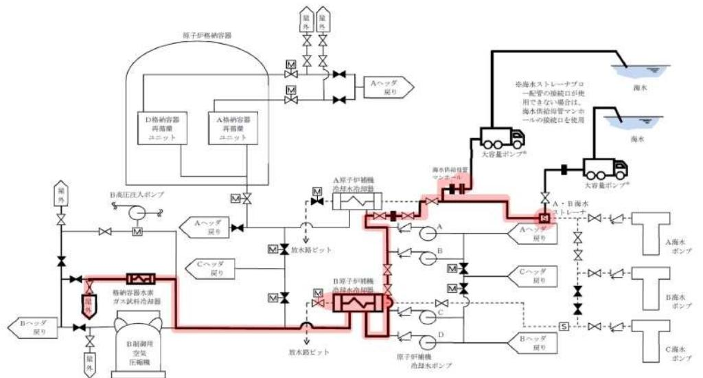
大飯 3／4号炉 海水供給に使用する接続口
