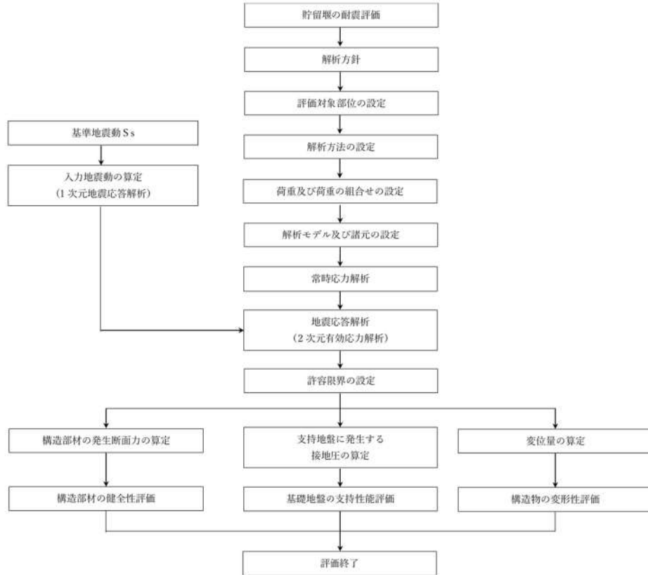
図8 貯留堰検討フロー（耐震評価）
