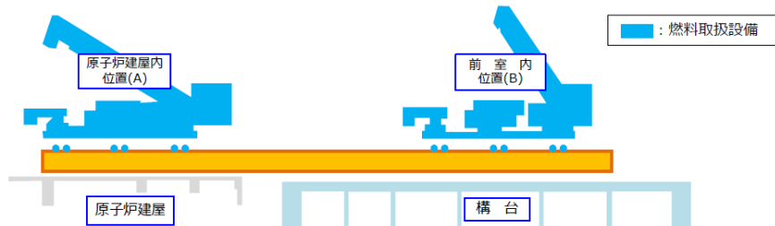
図 4.2.1-1 燃料取扱設備の位置
