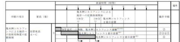
第1.12.7図 海洋への拡散抑制設備(シルトフェンス)による海洋への放射性物質の拡散抑制 タイムチャート
