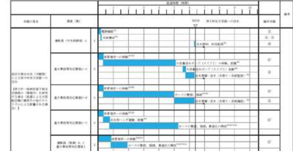
第1.4-14図 低圧代替注水系（可搬型）による原子炉圧力容器への注水 タイムチャート
