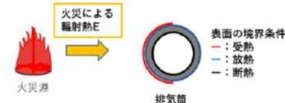
第2.3.2.3-2図 排気筒の評価概念図
