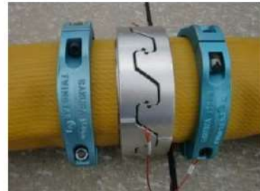
可搬型ホース（150A）接続後
