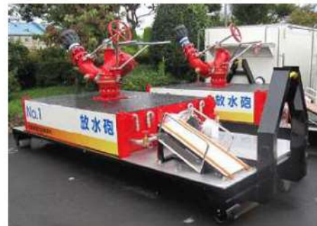
第7図 可搬型大容量海水送水ポンプ車及び放水砲
