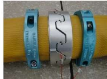
可搬型ホース (150A) 接続後
