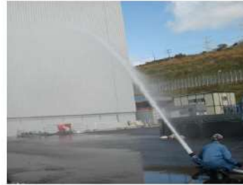
可搬型スプレイノズルによる スプレイ状況 (屋外での模擬訓練)
