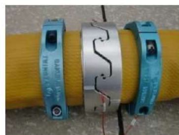
可搬型ホース(150A)接続後
