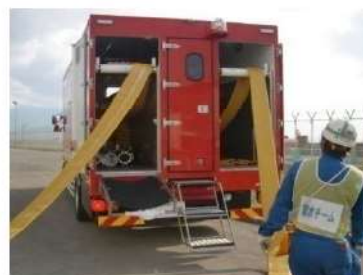
ホース延長・回収車（送水車用）による 可搬型ホース敷設 （屋外 T. P. 33. 1m）
