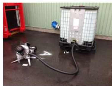
小型放水砲及び泡消火薬剤
