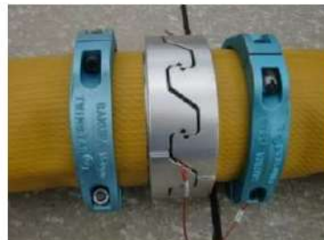
可搬型ホース(150A)接続後
