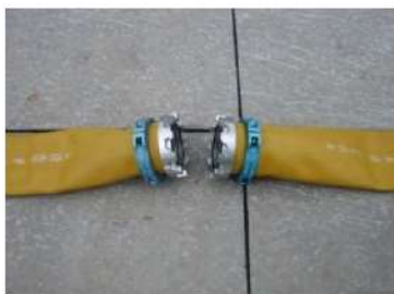
可搬型ホース(150A)接続口
