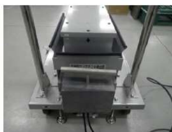
可搬型エリアモニタ 検出器側
