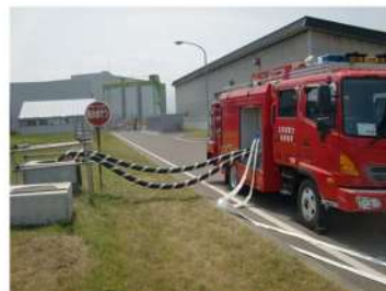
水源への吸管挿入 (屋外 T.P. 10.3m)
