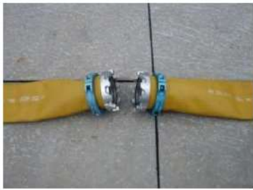
可搬型ホース（150A）接続前
