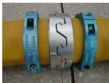
可搬型ホース(150A) 接続後
