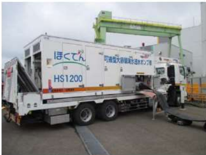
可搬型大容量海水送水ポンプ車の設置 (屋外 T.P. 10.3m)
