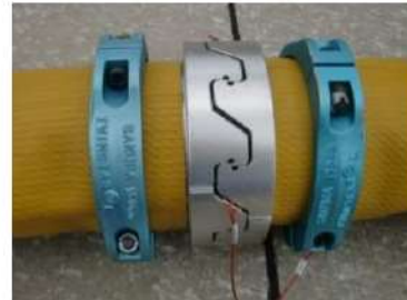
可搬型ホース(150A)接続後
