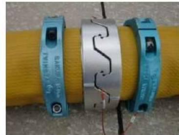
可搬型ホース (150A) 接続後
