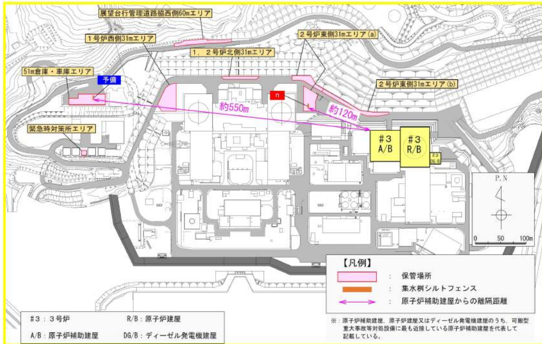
集水枘シルトフェンスと原子炉補助建屋との離隔距離
