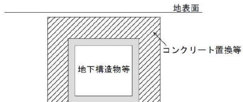
第 6-43 図 浮き上がり対策工概念図
