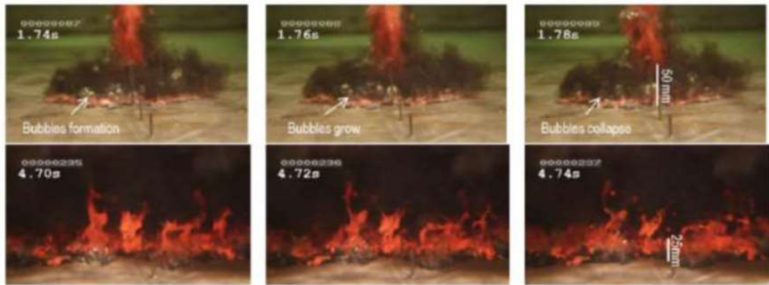
図 3.1-46 PULiMS-E4 試験での溶融物拡がり挙動
