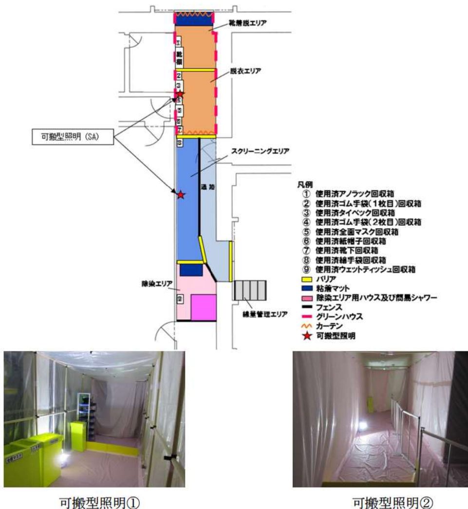
図 3.2-7 可搬型照明 (SA) 確認状況
