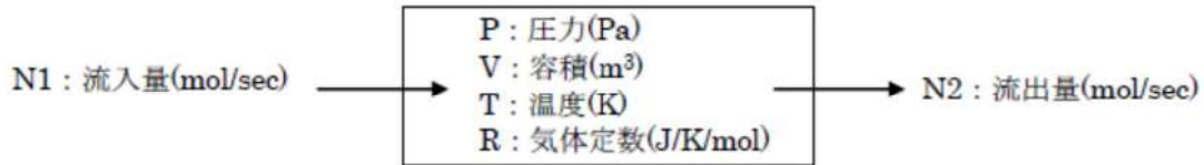
図2.4-10 緊急時対策所指揮所及び緊急時対策所待機所加圧バウンダリ正圧化モデル
