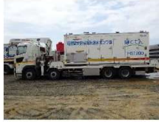
可搬型大容量海水送水ポンプ車
