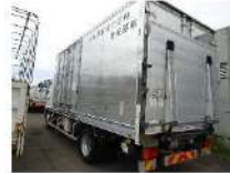
大規模損壊対応用変圧器車
