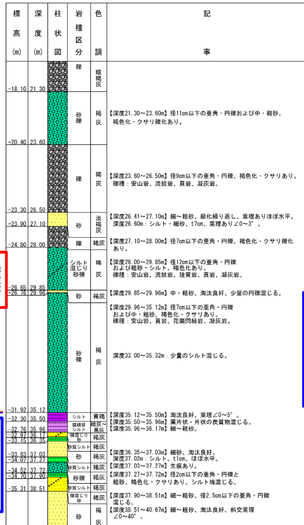
ボーリング柱状図 (深度20~40m)
