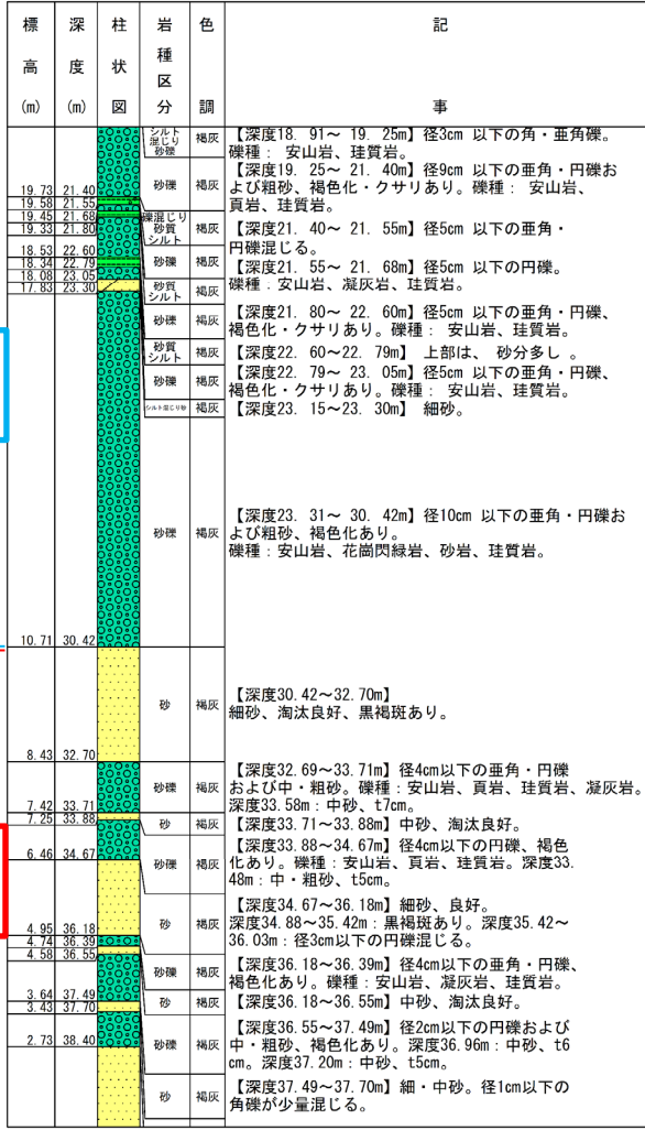
ボーリング柱状図(深度20~40m)
