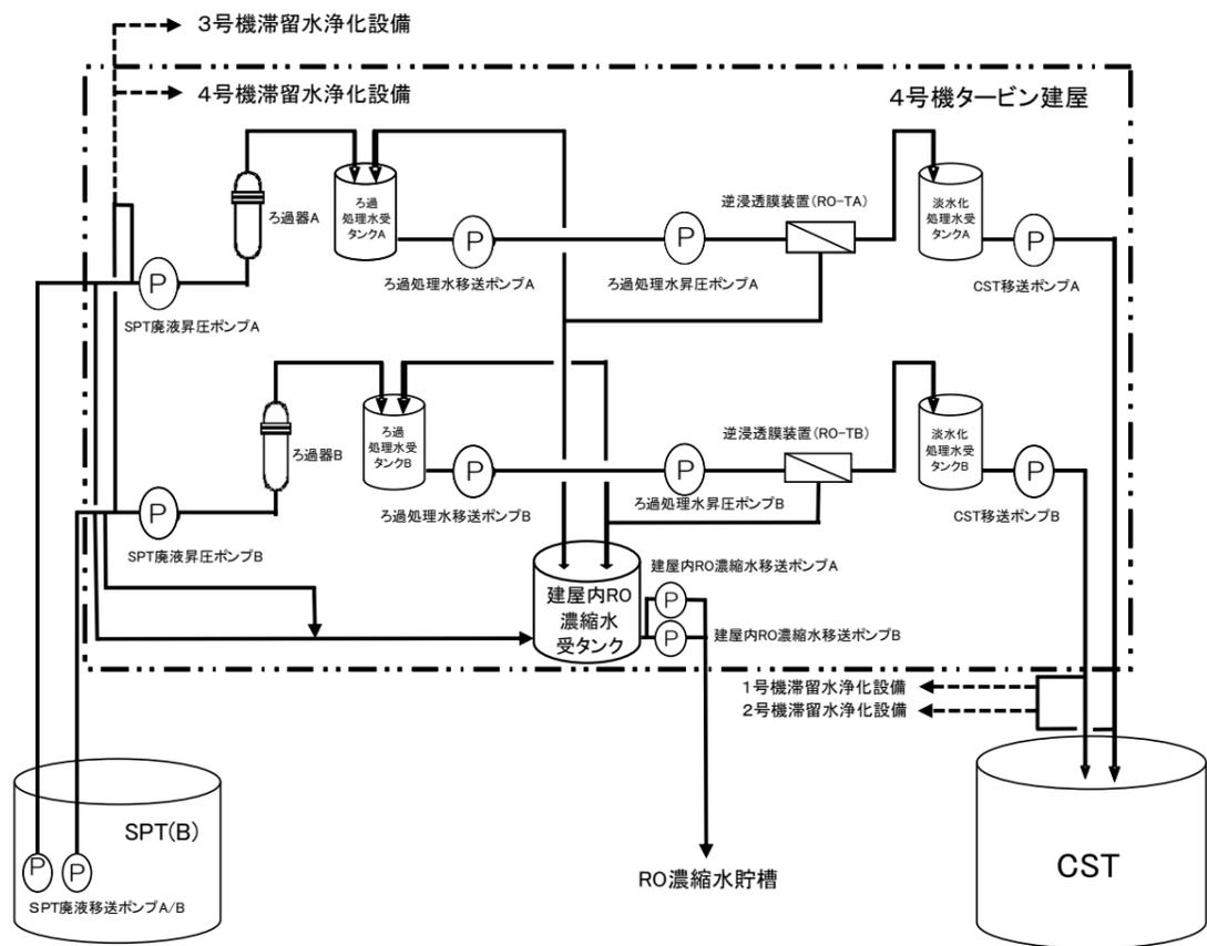
図-8 淡水化装置（逆浸透膜装置）及び滞留水浄化設備の系統構成図（2/2）
