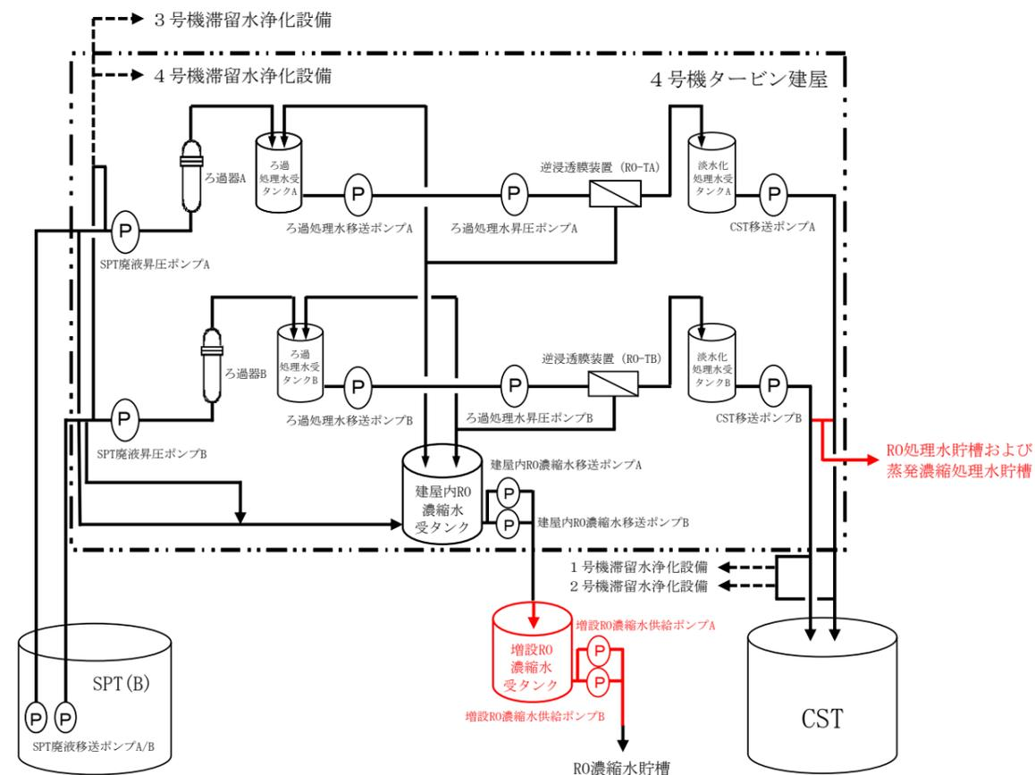
図-8 淡水化装置（逆浸透膜装置、蒸発濃縮装置）及び滞留水浄化設備の系統構成図（2/2）
