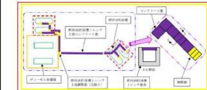
図1. ディーゼル発電機燃料油貯油槽トレンチの配置及び構造概略図
