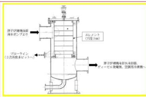
図1 原子炉補機冷却海水ポンプ出口ストレーナ
