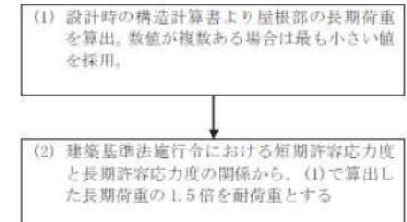
図1 評容堆積荷重算定フロー
