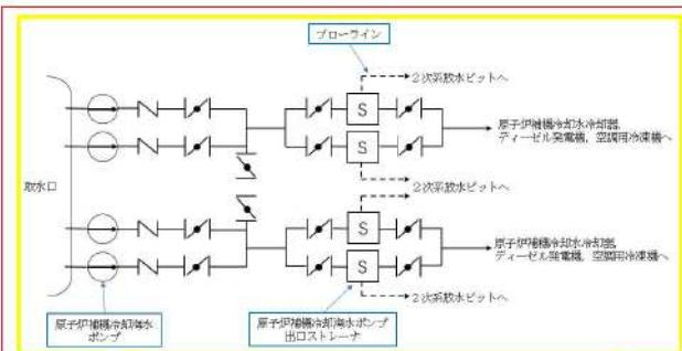
図2 原子炉補機冷却海水ポンプ出口ストレーナ
