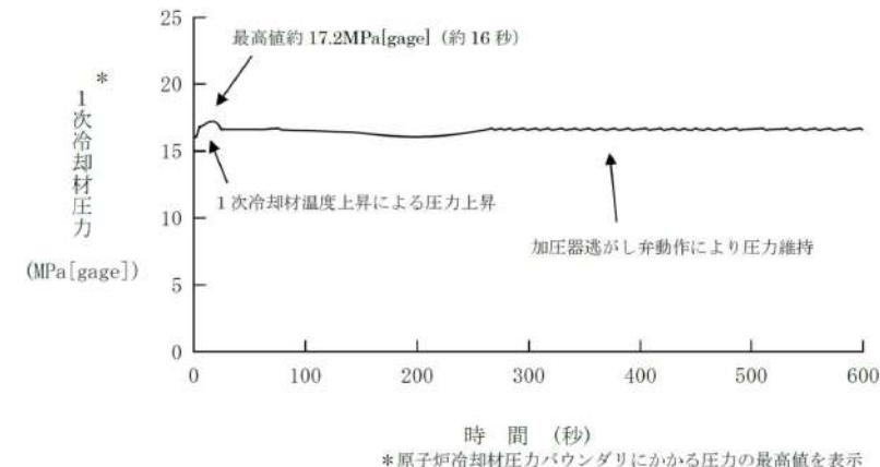
図3 1次冷却材圧力の推移
