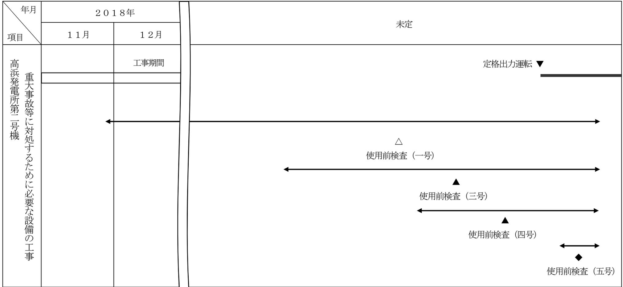
△ 材料検査、寸法検査、外観検査、組立て及び据付け状態を確認する検査、耐圧検査、漏えい検査
