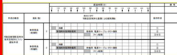
図3.2-12 可搬型新設緊急時対策所空気浄化ファンによる正圧化 (ブルーム通過前) のタイムチャート (操作手順 a.)
