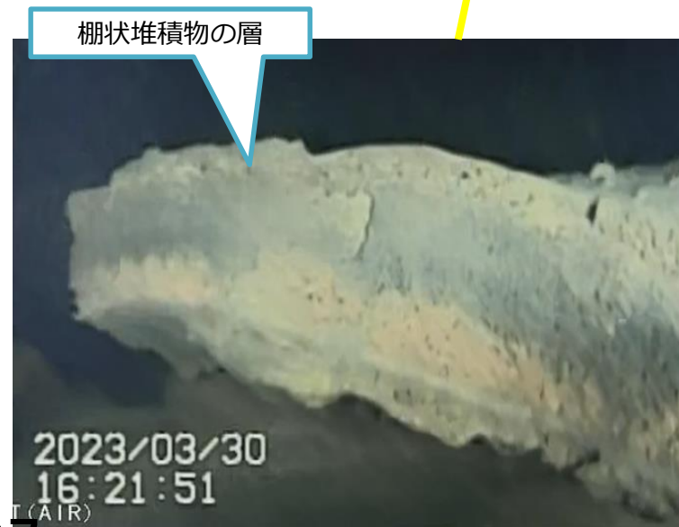
写真3. ペDESTAL外棚状堆積物断面
