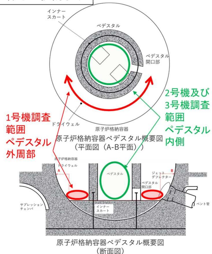
2号機及び3号機の調査範囲(ペデスタル内側)と1号機の調査範囲(ペデスタル外周部)は異なるが、2号機及び3号機では、ペデスタルのコンクリート損傷、テラス状構造、半球状堆積物等は確認されていない。
