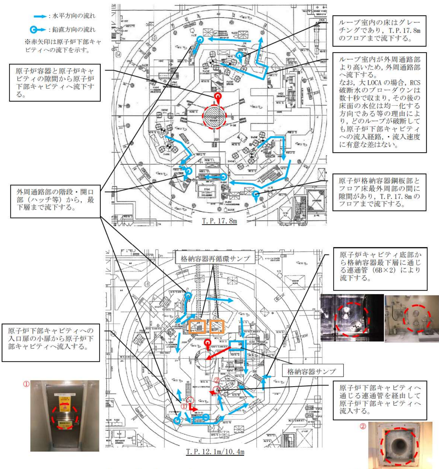
図2 スプレイ水及びRCS破断水の原子炉下部キャビティへの流入経路 (T. P. 17.8m, T. P. 12.1m/10.4m 平面図)
