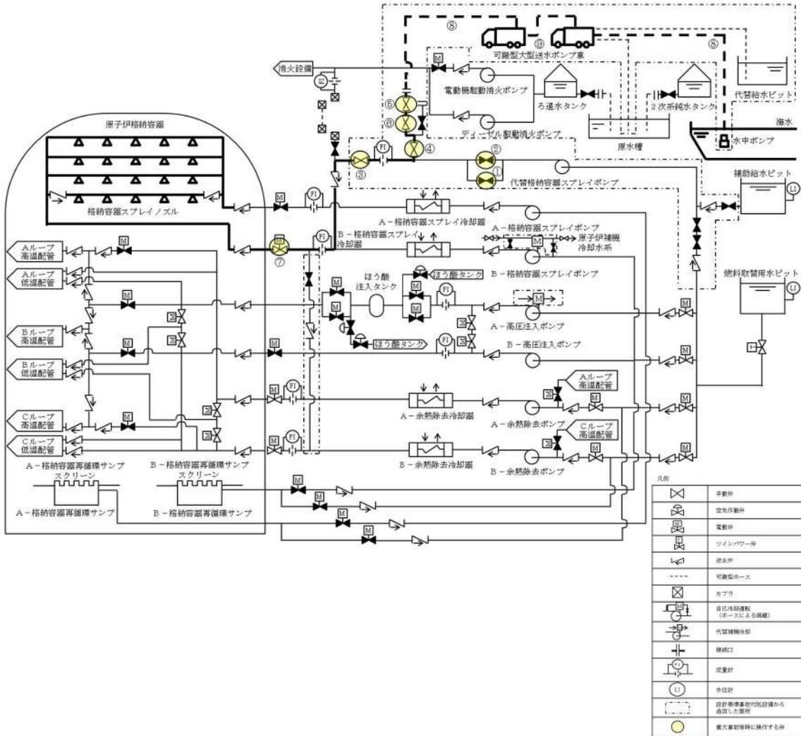
図 50-14-2 海水を用いた可搬型大型送水ポンプ車による原子炉格納容器内へのスプレイの概要図
