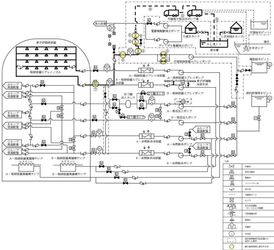
図 50-14-4 原水槽を水源とした可搬型大型送水ポンプ車による原子炉格納容器内へのスプレィの概要図
