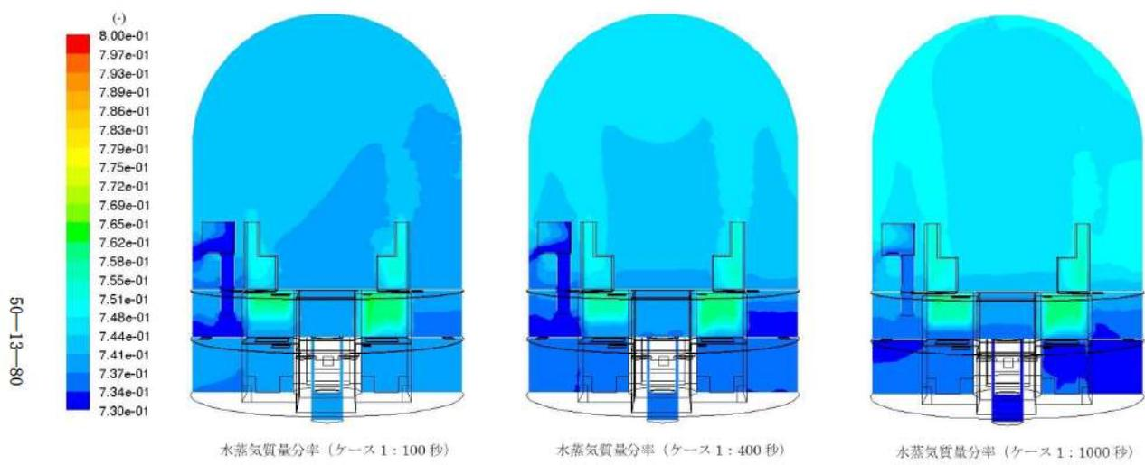
図 15 水蒸気質量分率分布図(ケース 1)
