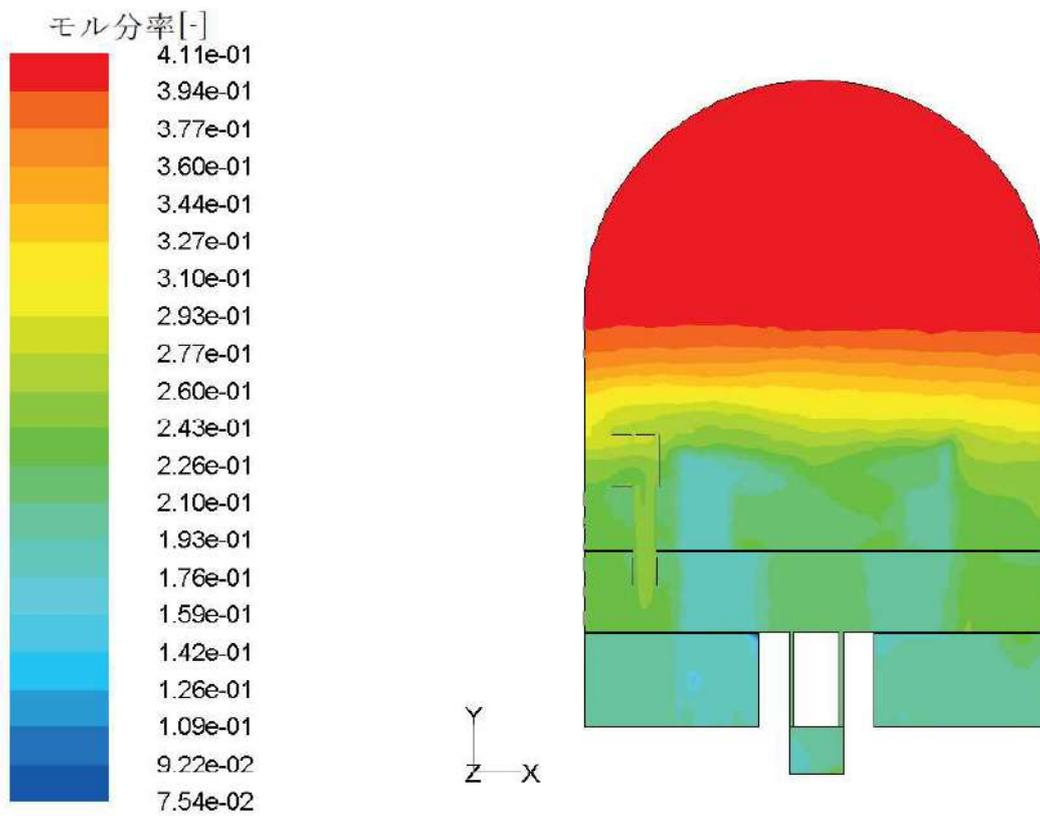
図 11 水蒸気モル分布 (3600 秒, ループ室破断)
