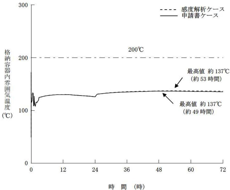
図2 格納容器内雰囲気温度の推移
