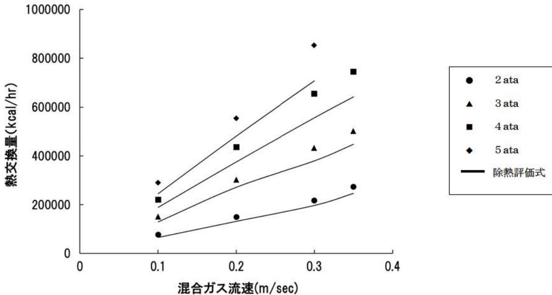
図3. 2-1 混合ガス流速に対する冷却コイル熱交換量 (冷却水流量:  $13 \text{ m}^3/\text{h}$ )
