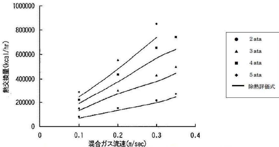
図5. 1-1 混合ガス流速対除熱量（図3. 2-1の再掲）
