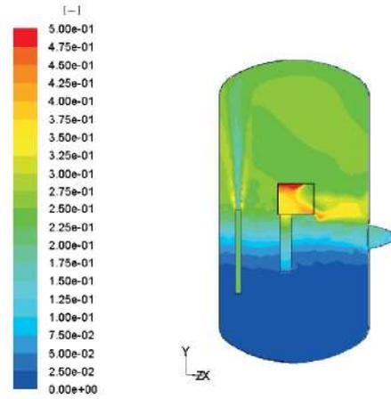
図 2.49 ST4-2 試験 DW1-ヘリウムモル分分布 (2,000 秒、Phase2)
