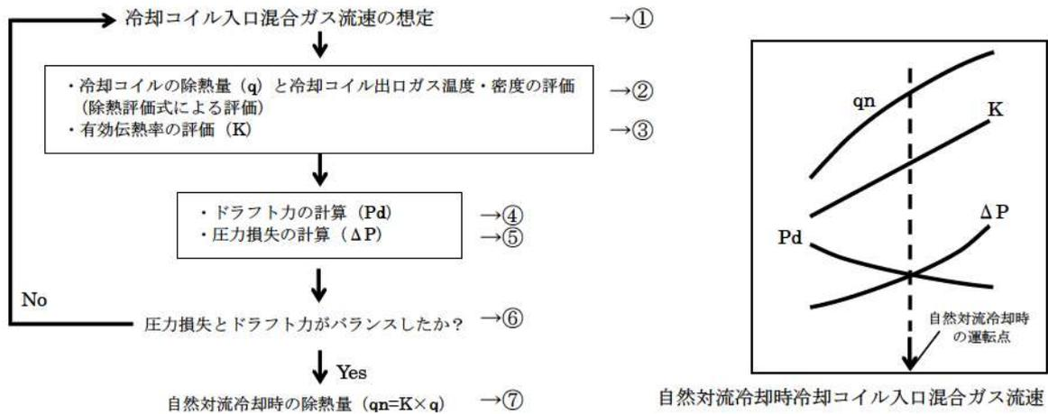
図 4. 4-1 自然対流冷却の除熱量評価フロー
