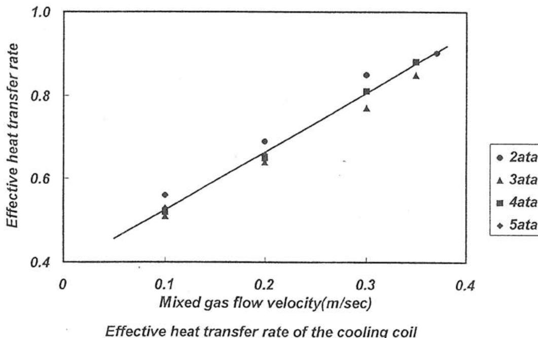
図4. 3-6 冷却コイルの有効伝熱率
