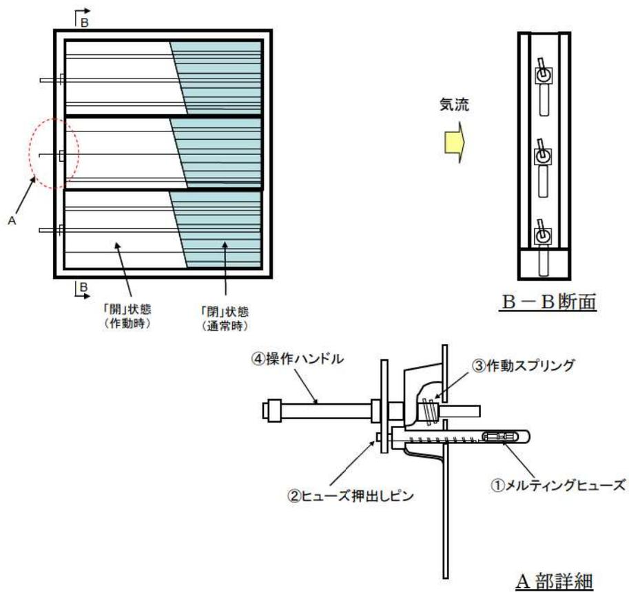
図 1-5 ダクト開放機構概略図
