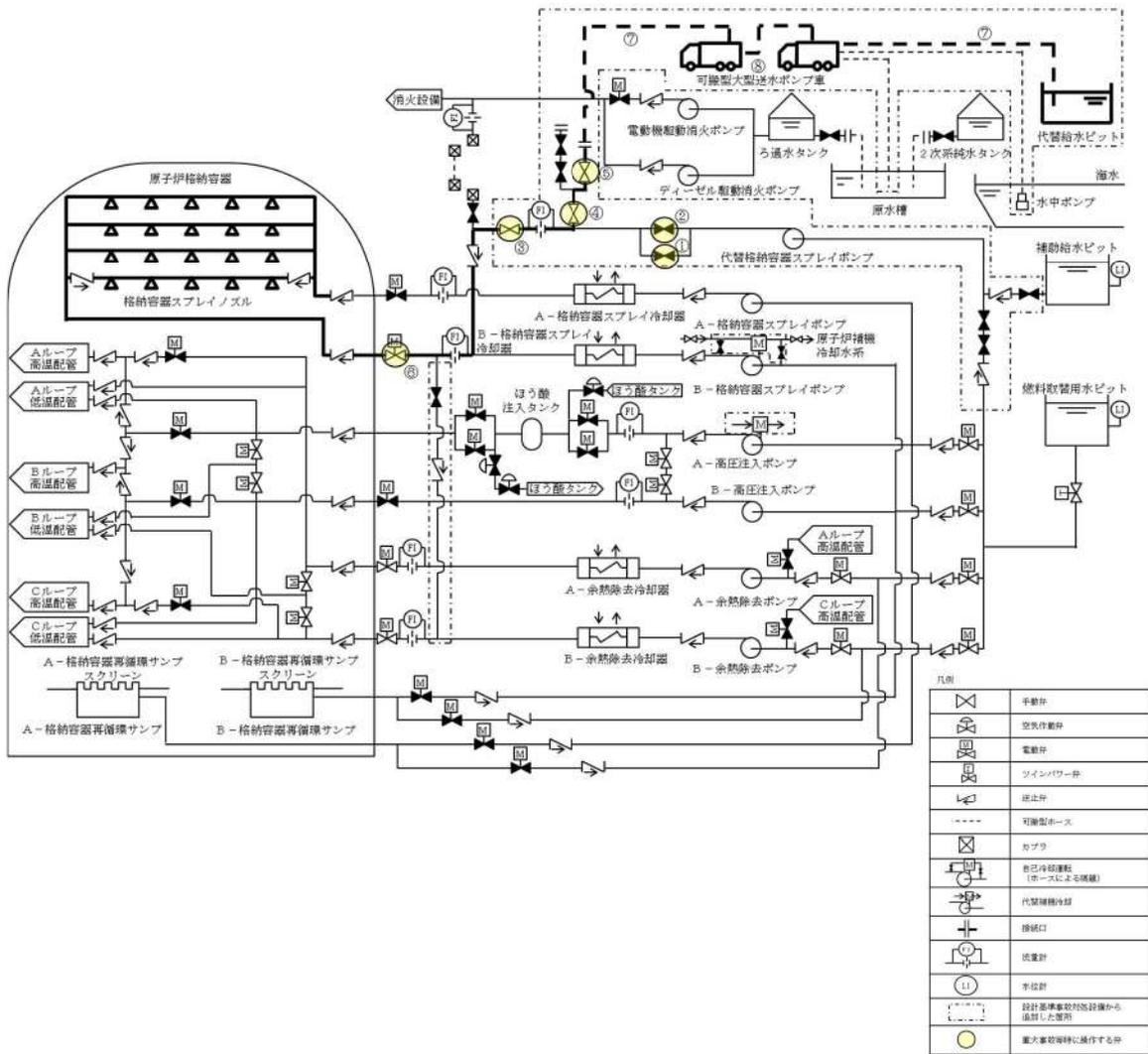
図 50-14-3 代替給水ピットを水源とした可搬型大型送水ポンプ車による原子炉格納容器内へのスプレイの概要図
