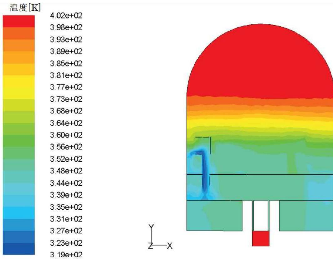
図 10 温度分布 (3600 秒, ループ室破断)
