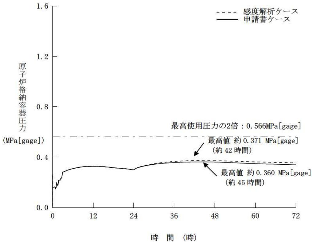
図1 原子炉格納容器圧力の推移
