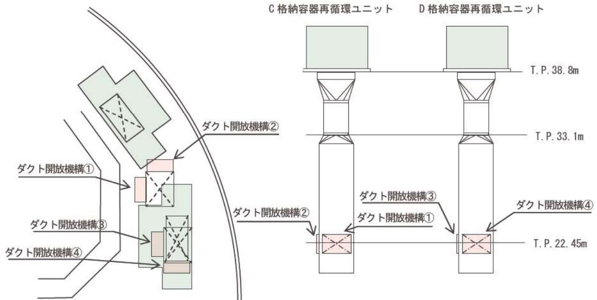
図1-9 格納容器再循環ユニット及びダクト開放機構配置概略図
