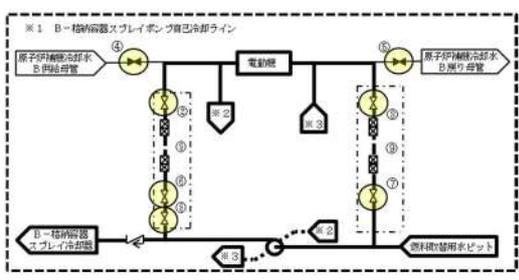
図 50-14-5 B-格納容器スプレイポンプ（自己冷却）による原子炉格納容器内へのスプレイの概要図
