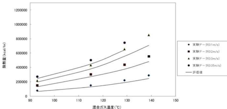
図5. 2-2 実験による確認試験データと除熱評価との比較
