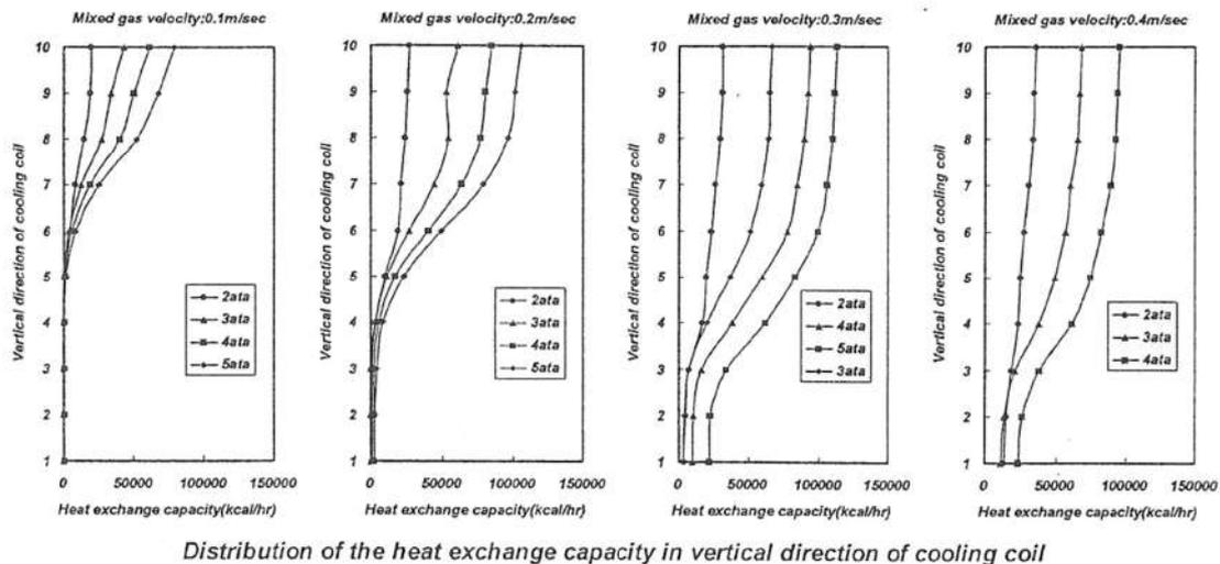
図4. 3-1 冷却コイル高さ方向の除熱分布
