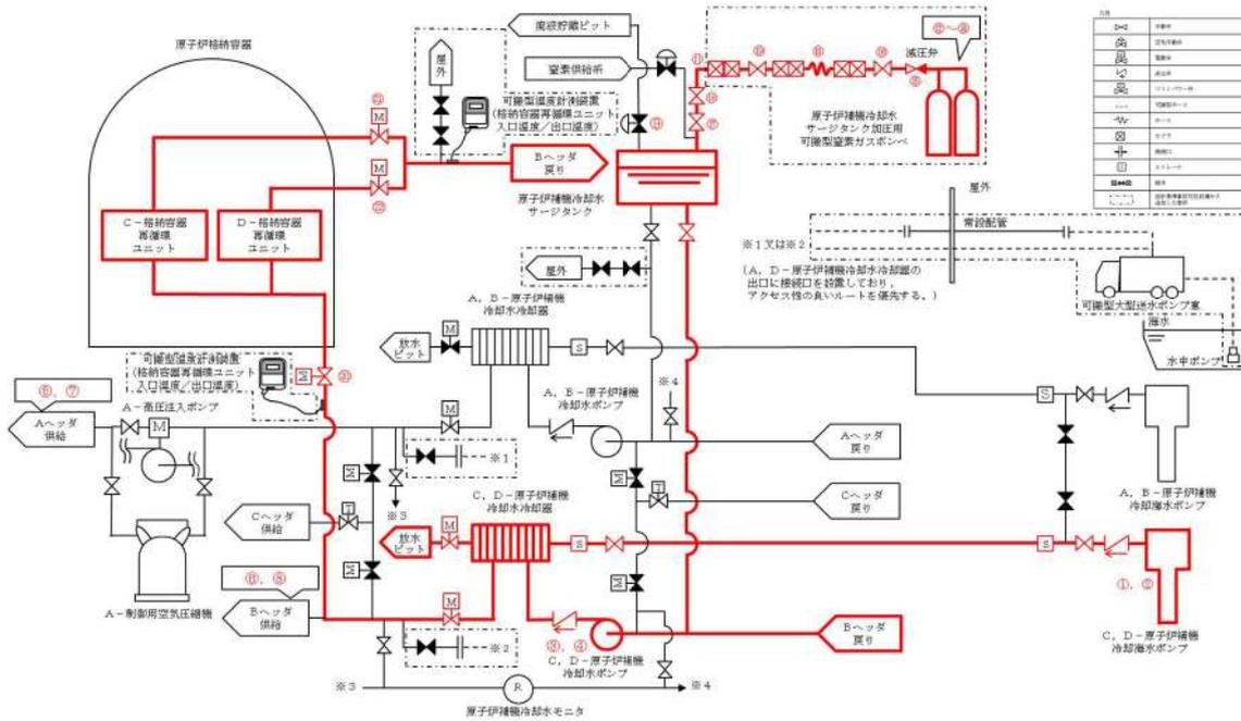
図 50-4-1 C, D-格納容器再循環ユニットによる格納容器内自然対流冷却
