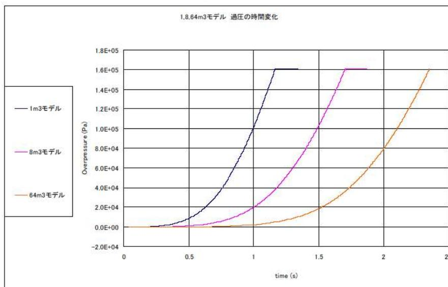
図4 1m<sup>3</sup>、8m<sup>3</sup>及び64m<sup>3</sup>での圧力変化（H<sub>2</sub>濃度 8%）
