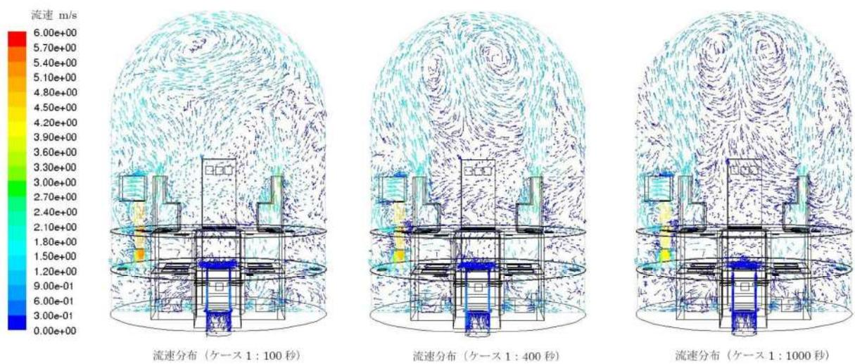
図 13 流速分布図(ケース1)
