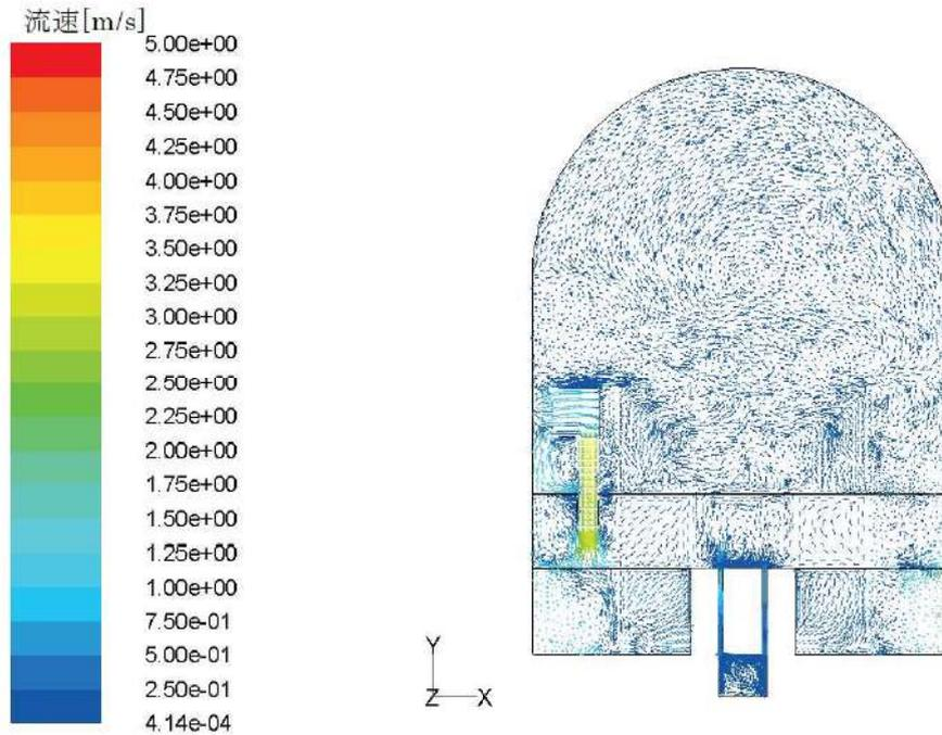
図9 流速分布(3600秒，ループ室破断)
