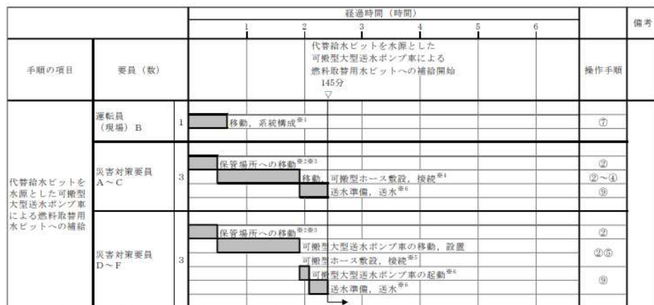
図2.13-13 原水槽を水源とした可搬型大型送水ポンプ車による燃料取替用水ピットへの補給 タイムチャート
