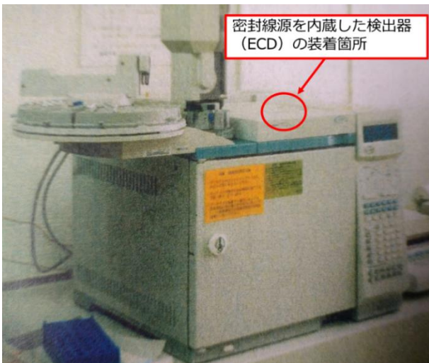
密封線源を内蔵した検出器（ECD）が装着された分析装置（アジレント GC6890A） （平成13年（2001年）撮影）
