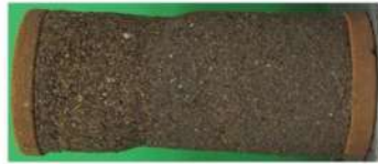
試験後の供試体
