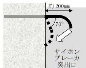
図3 上部からの落下物による曲げによるサイホンブレーカの座屈変形
