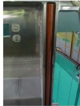
ゲートパッキンの装着状況
