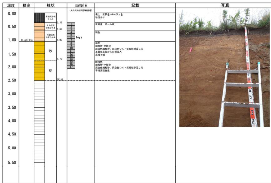
火山灰試料採取箇所① 露頭柱状図
