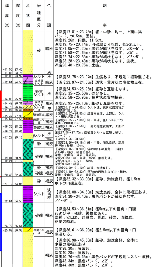
ボーリング柱状図 (深度20~40m)
