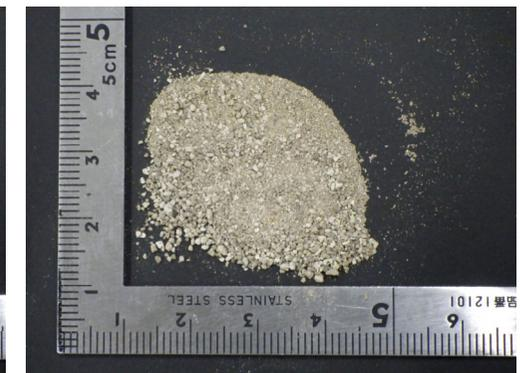
採取試料 (粉碎後, 深度6.55～6.60m)
