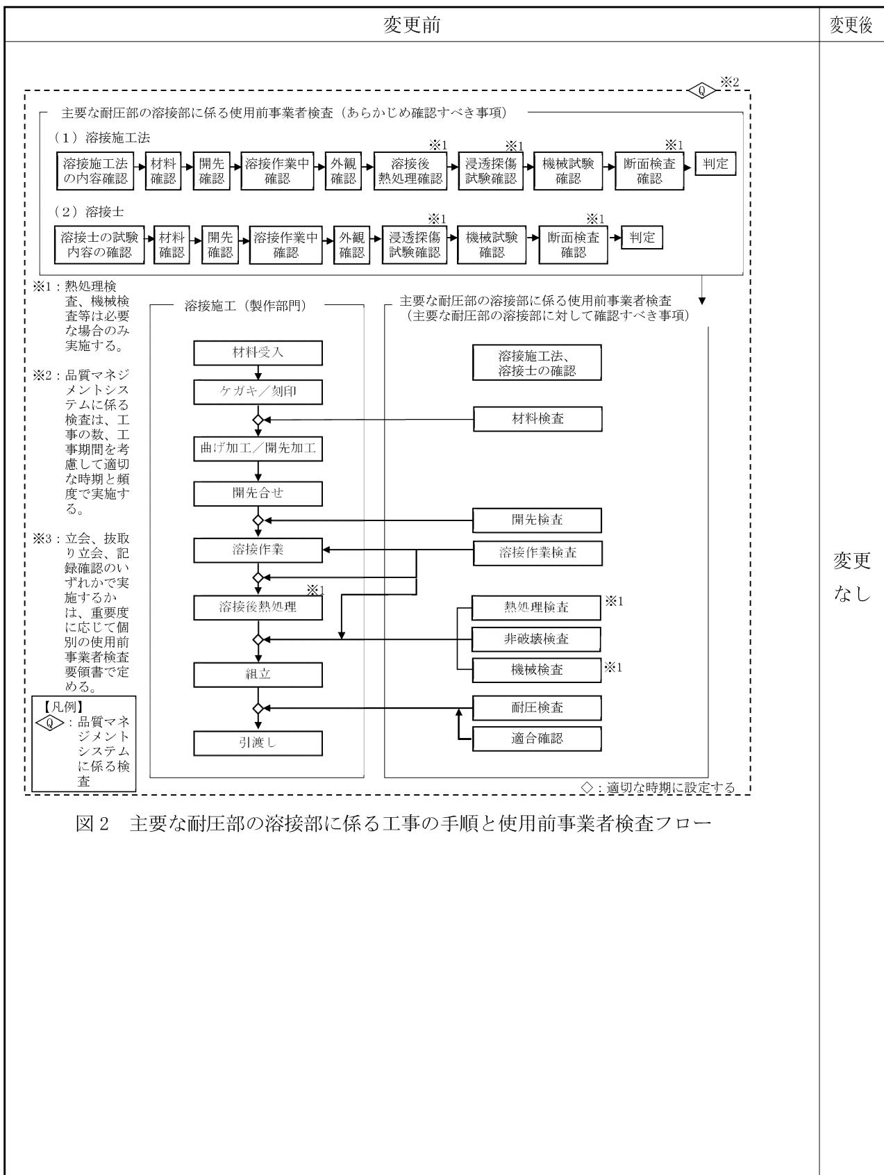
図2 主要な耐圧部の溶接部に係る工事の手順と使用前事業者検査フロー
