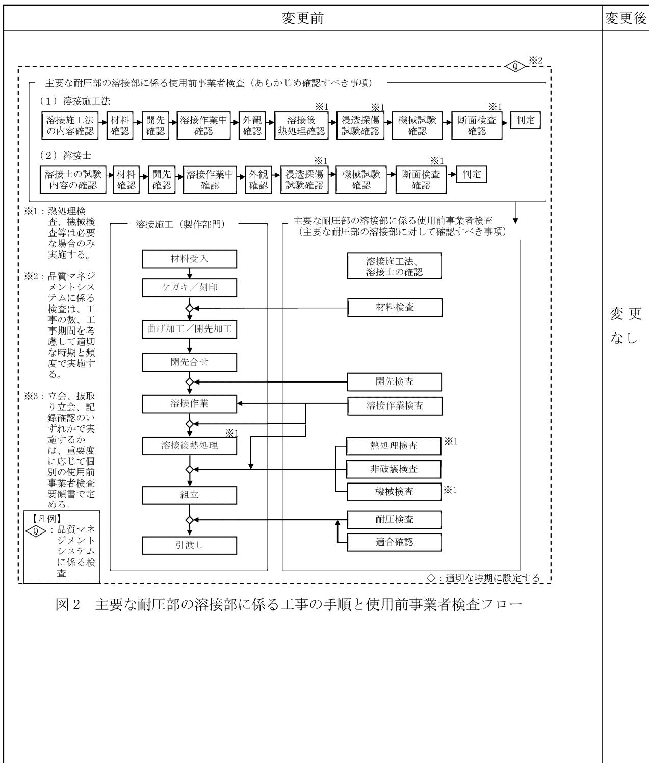
図2 主要な耐圧部の溶接部に係る工事の手順と使用前事業者検査フロー
