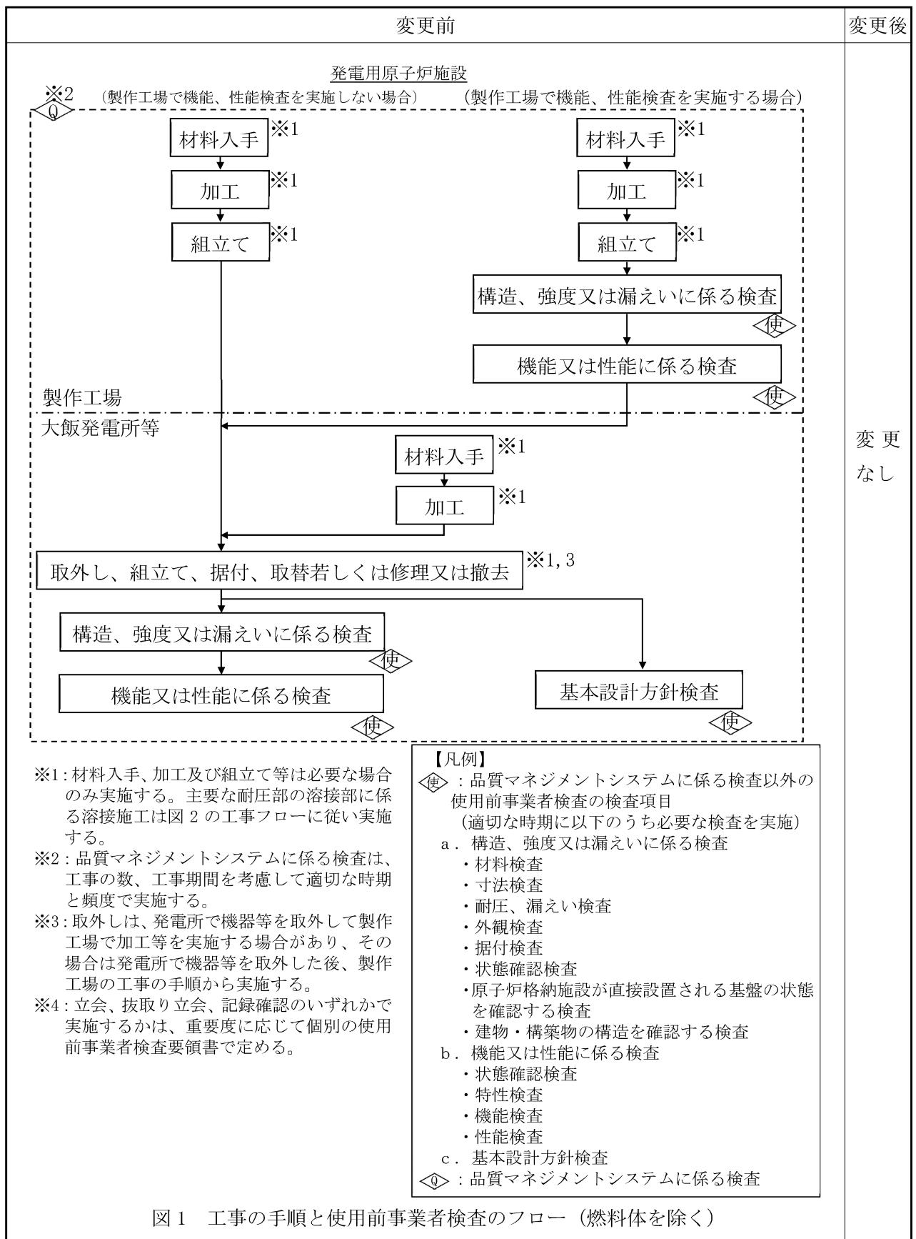
図1 工事の手順と使用前事業者検査のフロー（燃料体を除く）
