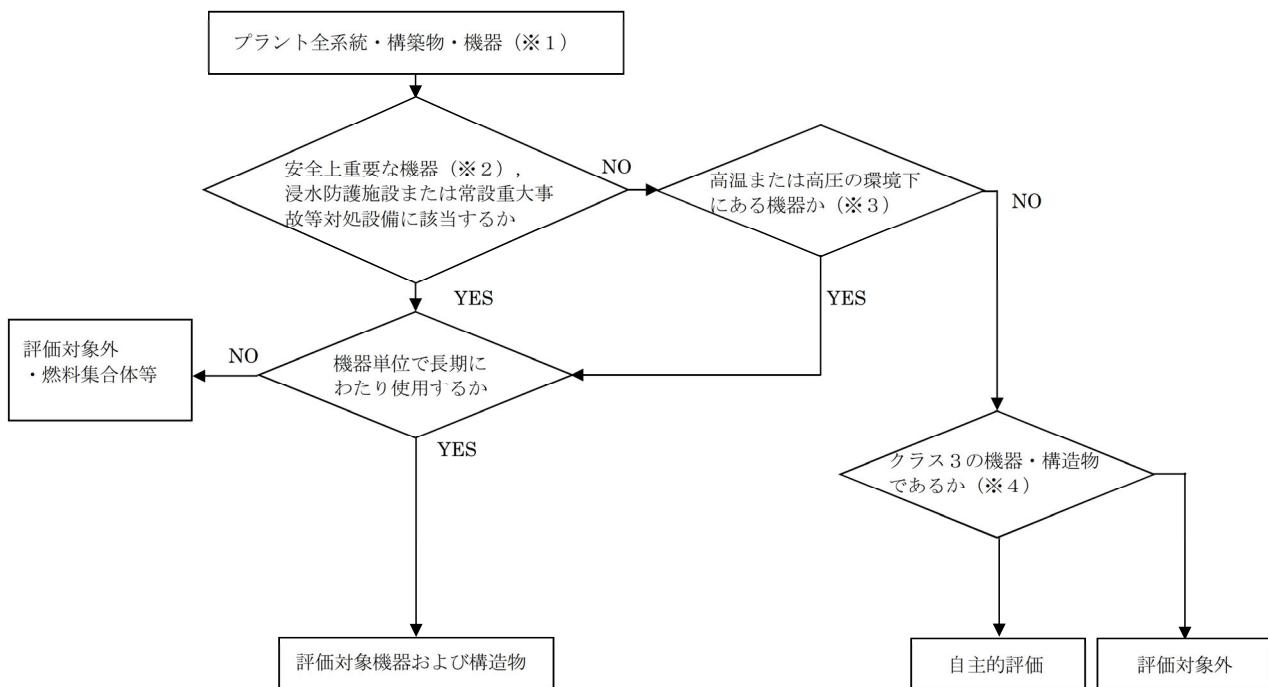
※1：重要度分類審査指針で定義される機器（クラス1，2，3）（実用炉規則別表第二において規定される浸水防護施設に属する機器および構造物を含む。）
