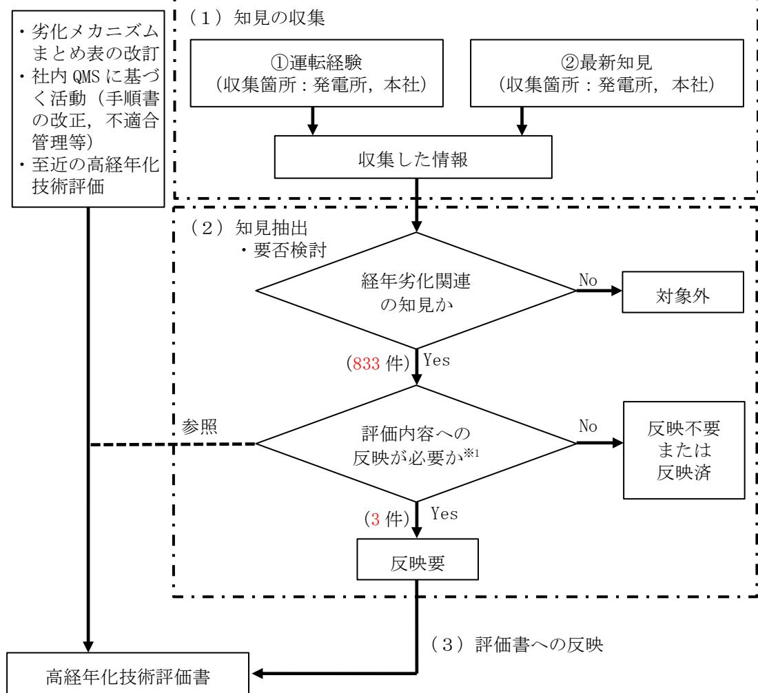
また、新たに発生したトラブル・保全品質情報について、高経年化技術評価に反映される流れを下図に示す。
