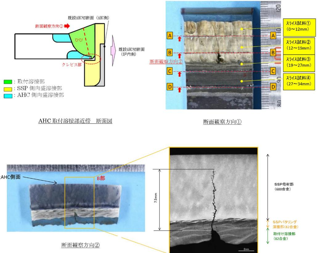
図3 AHC 径方向のひびの一例
