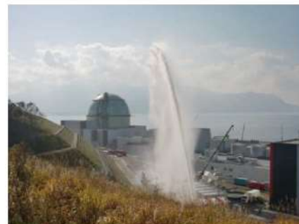
第10図 直状放射による放水状況
