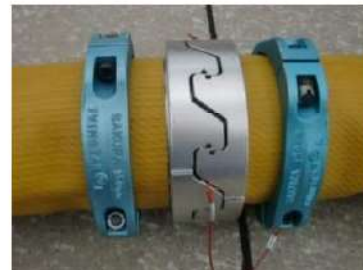
可搬型ホース（150A）接続後
