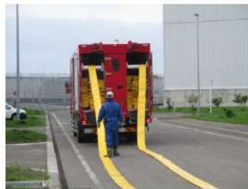
ホース延長・回収車（送水車用）による可搬型ホース敷設 (屋外 T. P. 10. 3m)
