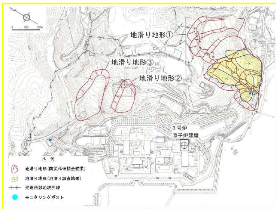
第 3-3 図 泊発電所周辺の地滑り地形及び対象施設（安全施設）位置図
