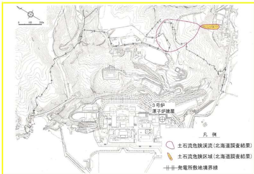
第 1.12.1-2 図 泊発電所周辺における土石流危険区域及び土石流危険溪流位置図
