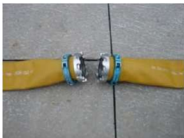
可搬型ホース (150A) 接続前
