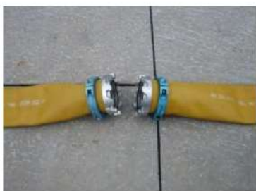
可搬型ホース (150A) 接続前
