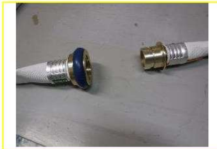
消防ホース (40 A) 接続前
